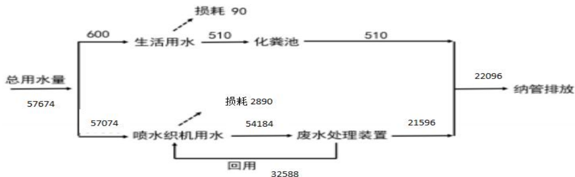
图 2-1 项目用水平衡图
