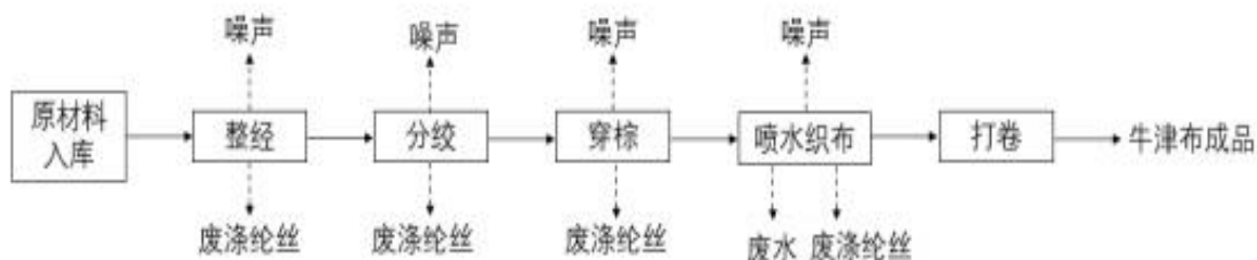
图 2-2 本项目牛津布生产工艺及产污环节图
