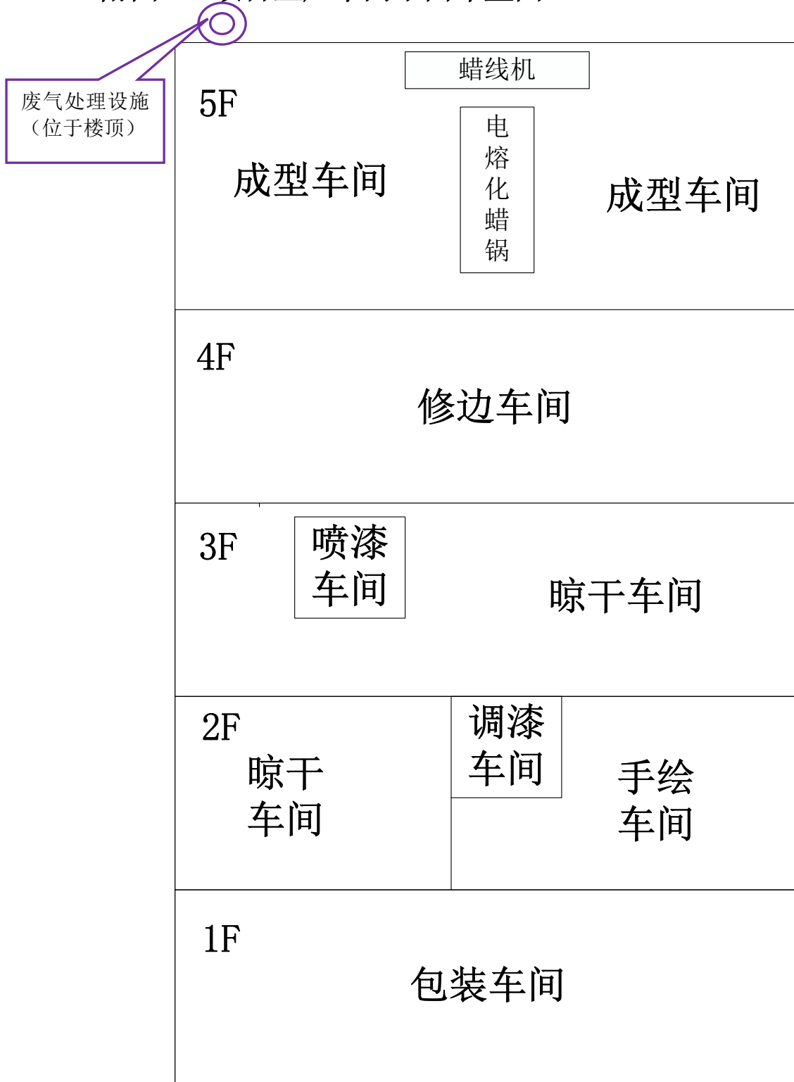
附图 2：项目生产车间平面布置图
