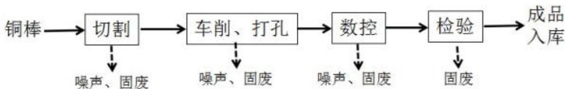
图 2-2 本项目主要生产工艺及产污环节
