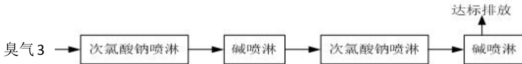
图 4.1-3 臭气 3（老污水站臭气）处理流程图
