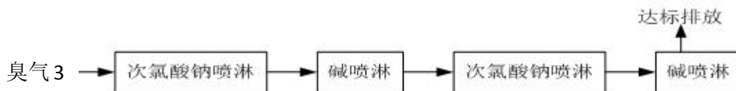
图 4.1-3 臭气 3（老污水站臭气）处理流程图
