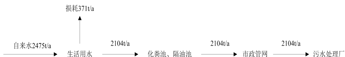
图 3.4-1 本项目水平衡图（单位：t/a）
